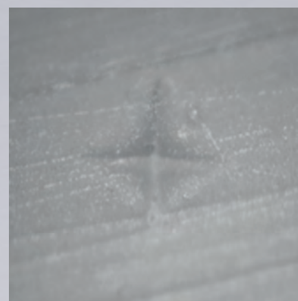
CEREC Tessera Вдавнення після глазурування (матричне сікання) при 760°С протягом 2 хв. Поверхня згладжується, а волосяні переломи заклеюються.
